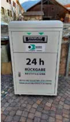
Seit Kurzem steht im Widumhof hinter der Mauer ein Metallbehälter. Es ist eine Bücherbox, in die ausgeliehene Medien auch außerhalb der Öffnungszeiten eingeschoben werden können. Ein gefederter Boden, der bei zunehmendem Gewicht nach unten sinkt, ermöglicht eine schonende Schichtung der zurückgegebenen Medien. Die Box wird Dienstag, Mittwoch, Donnerstag und Freitag von den Mitarbeiter\*innen
